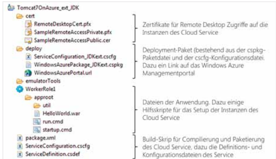
Abbildung 2: Projektaufbau eines Windows-Azure-Projekts in Eclipse
