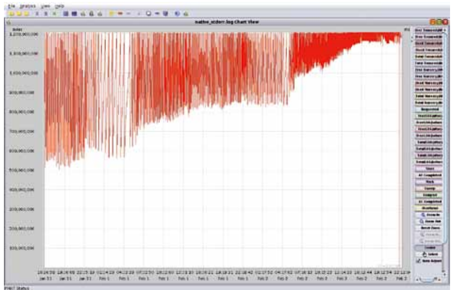
Abbildung 2: Das Pattern Modeling and Analysis Tool for Java Garbage Collection zeigt deutlich ein Memory Leak auf
