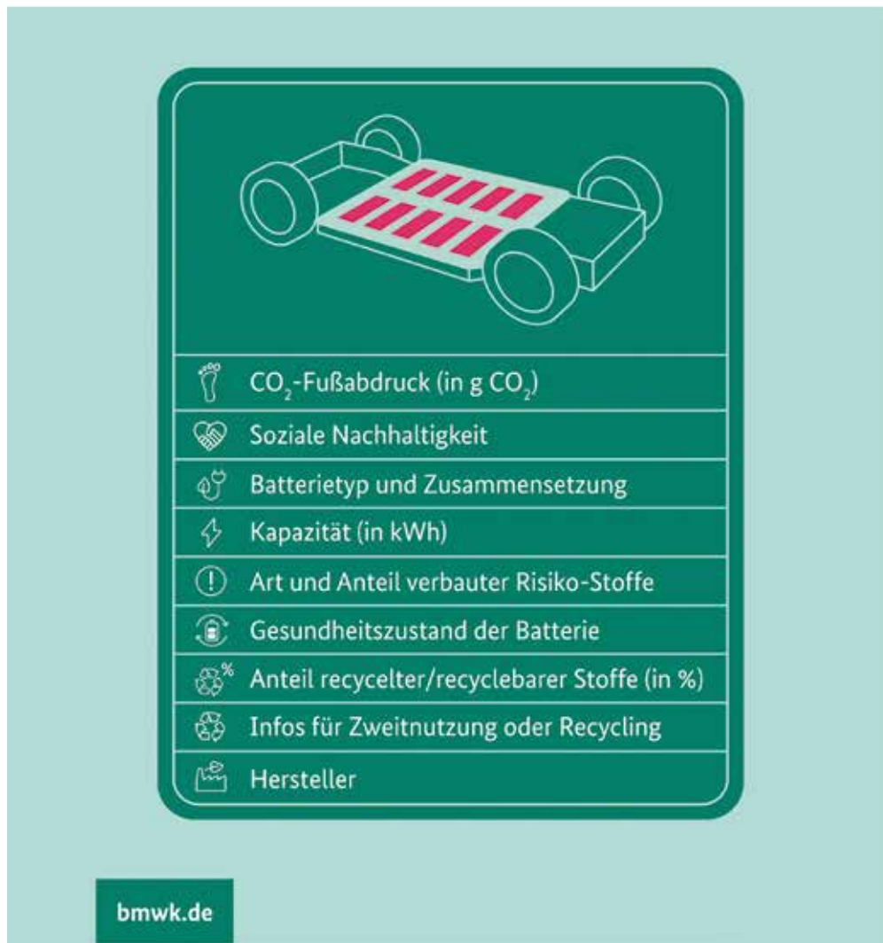
Abbildung 2: So könnte der Batteriepass aussehen. Der digitale Produktpass für Batterien bündelt alle relevanten Informationen entlang des gesamten Lebenszyklus: von der Rohstoffgewinnung bis zum Recycling (Quelle: BMWK)
