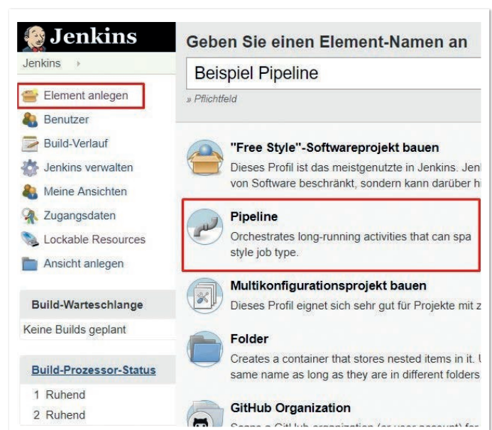
Abbildung 3: Erstellung einer neuen Jenkins Pipeline (Quelle: Moritz Reinwald)
