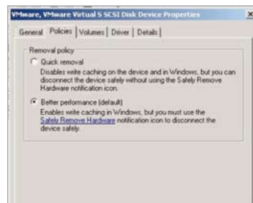
Abbildung 2: „Better Performance“ klingt gut, ist aber falsch – „Quick Removal“ ist dagegen richtig
