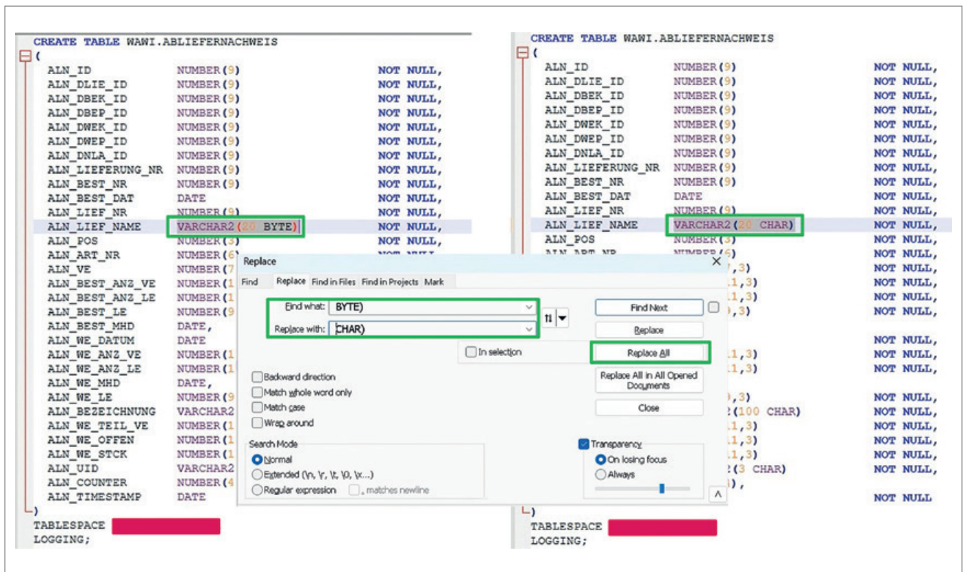
Abbildung 3: Ersetzen von BYTE durch CHAR in den Tabellen-Definitionen (Quelle: Lena Rudenko)
